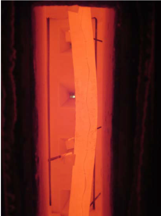
Flambage de la colonne
