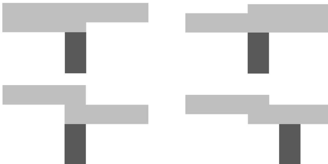
Ill. 44 : Exemples de différents types de décrochements de dalle
