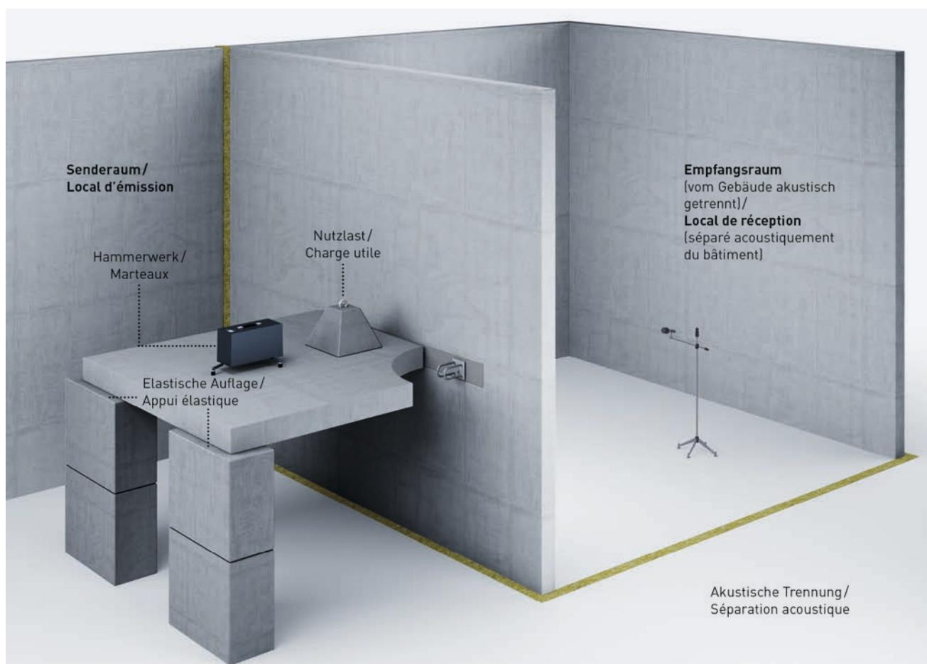
**Bild 5.** Prinzipieller Versuchsaufbau zur Ermittlung der Trittschallminderung eines CRET Silent Querkraftdorns am Fraunhofer Institut IPB in Stuttgart und an der EMPA in Dübendorf
