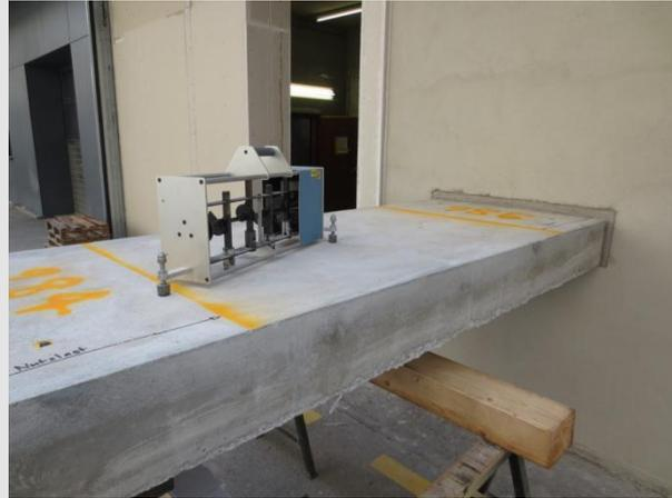
**Figure 8:** Montage de la dalle de palier sans charge utile au Fraunhofer Institut IBP
