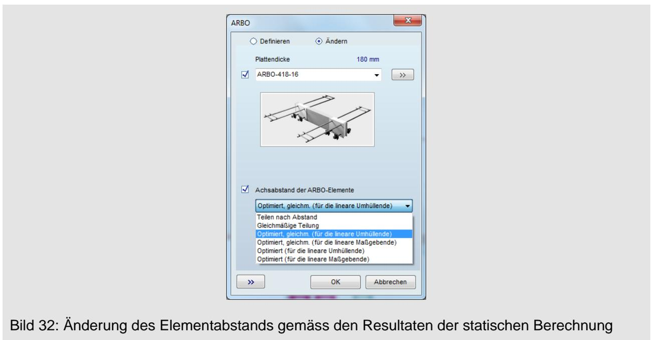
Bild 32: Änderung des Elementabstands gemäss den Resultaten der statischen Berechnung
