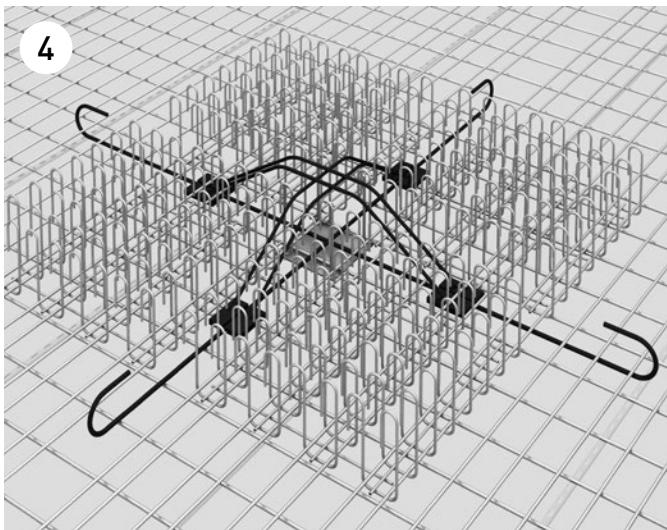
Das zweite DURA S-Element wird in Richtung der zweiten Bewehrungslage aufgestellt. Dieses Element ist etwas weniger hoch, so dass es in das erste DURA S-Element eingeschoben werden kann.
