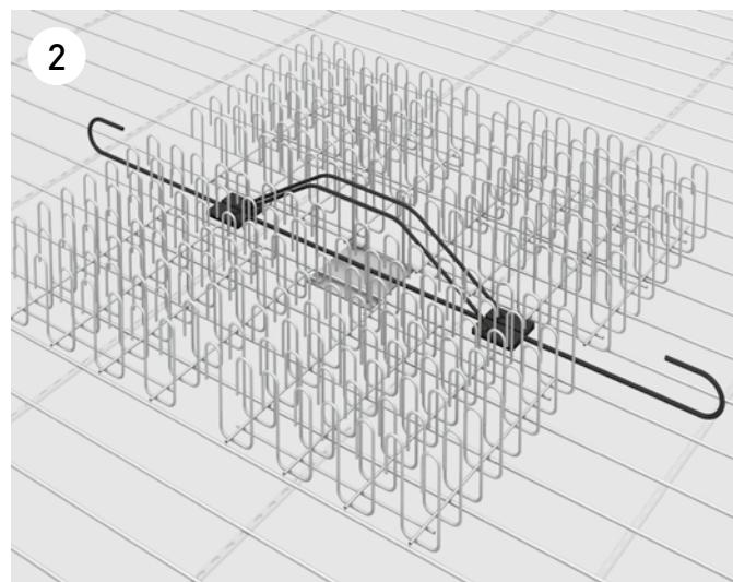
Das erste DURA S-Element wird in Richtung der ersten Bewehrungslage aufgestellt.
