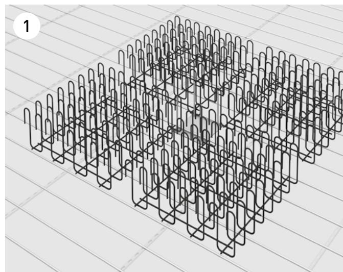
Die erste Bewehrungslage wird verlegt und die vier DURA Körbe werden parallel zu dieser Lage aufgestellt. Sie sind in sich stabil.
