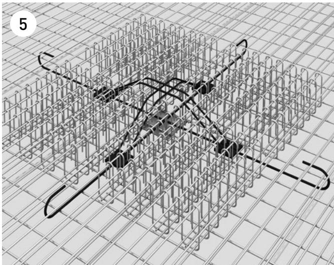
Die erste Lage der oberen Bewehrung (3. Lage) wird verlegt. Im Bereich des DURA Trapezes werden die Stäbe eingeschoben.
