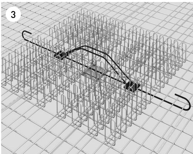
Die zweite Bewehrungslage wird verlegt. Im Bereich des DURA Trapezes werden die Stäbe eingeschoben.
