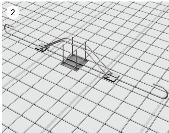
Die erste Bewehrungslage wird verlegt und das erste DURA S-Element wird parallel dazu aufgestellt.
