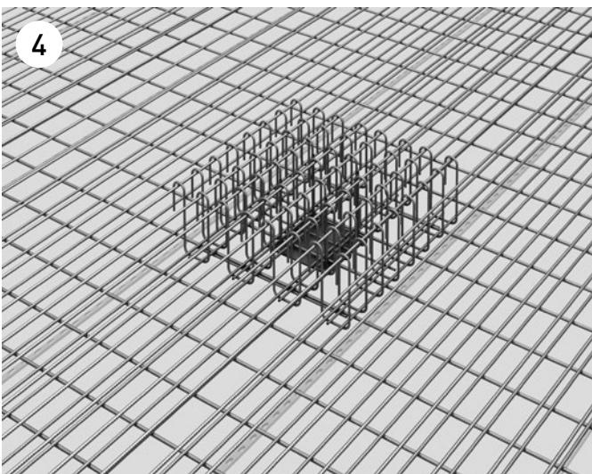
Die erste Lage der oberen Bewehrung (3. Lage) wird verlegt. Im Bereich des DURA Korbes muss der Stababstand der Bewehrung dem Bügelabstand des Korbes entsprechen, damit in jeden Bügelhaken ein Stab zu liegen kommt.
