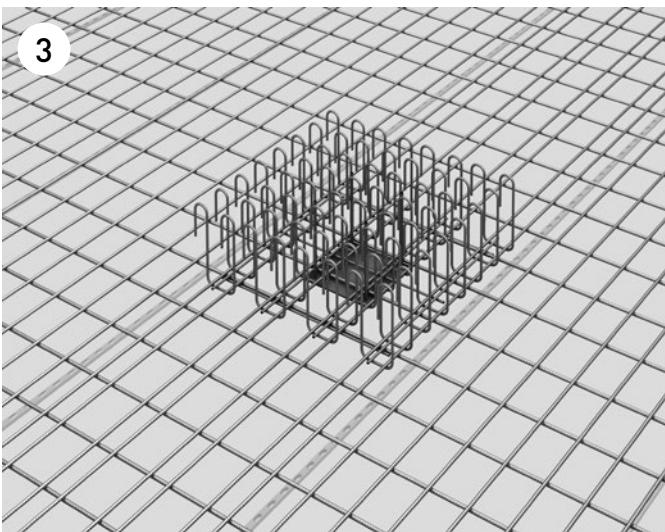
Die zweite Bewehrungslage wird verlegt. Im Bereich des DURA Korbes muss der Stababstand der Bewehrung dem Bügelabstand des Korbes entsprechen, damit in jeder Ecke eines Bügels ein Längsstab zu liegen kommt.
