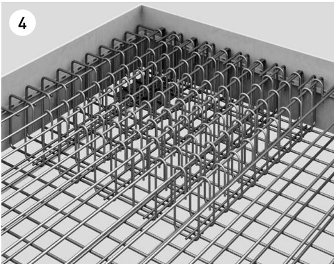
Die erste Lage der oberen Bewehrung (3. Lage) wird verlegt. Im Bereich des DURA Korbes muss der Stababstand der Bewehrung dem Bügelabstand des Korbes entsprechen, damit in jeden Bügelhaken ein Stab zu liegen kommt.
