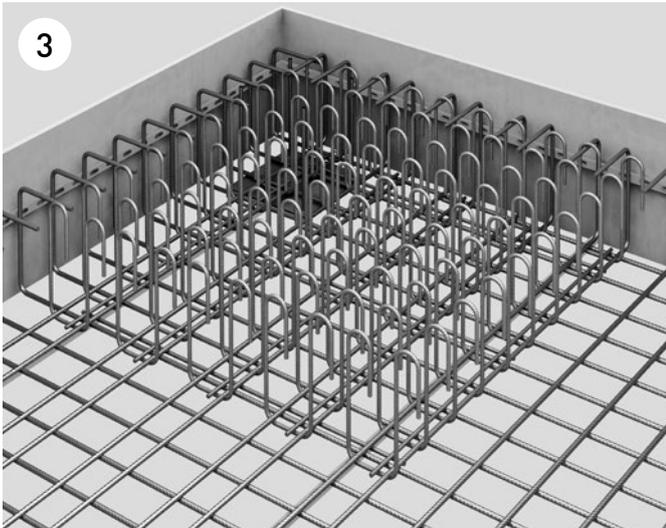
Die zweite Bewehrungslage wird verlegt. Im Bereich des DURA Korbes muss der Stababstand der Bewehrung dem Bügelabstand des Korbes entsprechen, damit in jeder Ecke eines Bügels ein Längsstab zu liegen kommt. Die Plattenrandverbügelung ist entsprechend dem Projekt zu integrieren.
