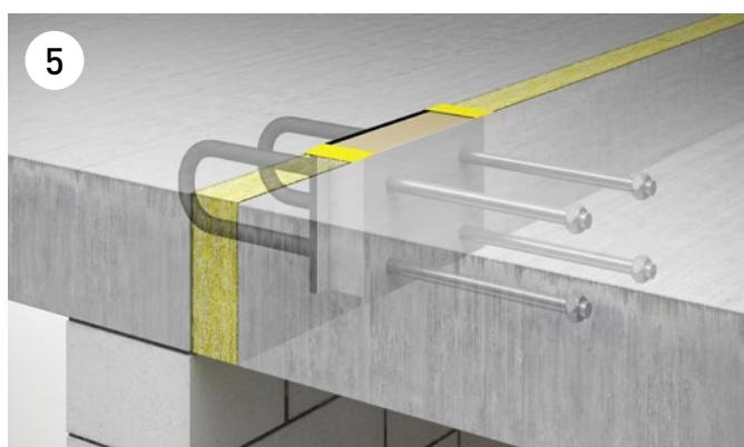
Betonieren der zweiten Platte. Nach dem Ausschalen die restliche Zement-Bojake in der Fuge entfernen.
