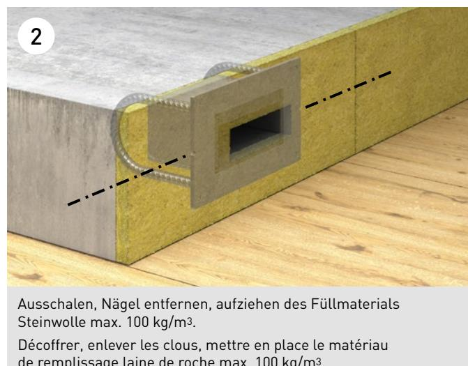
Ausschalen, Nägel entfernen, aufziehen des Füllmaterials Steinwolle max. 100 kg/m<sup>3</sup>.
