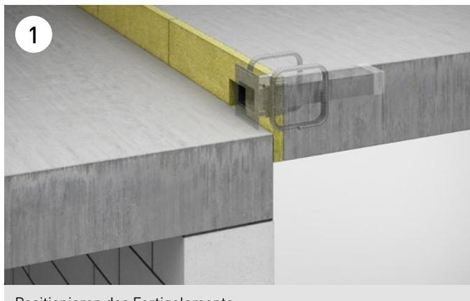
Positionieren des Fertigelements.
