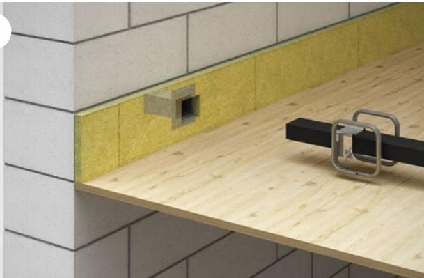
Aufziehen des Füllmaterials Steinwolle max. 100 kg/m<sup>3</sup> und Dorn einschieben.
