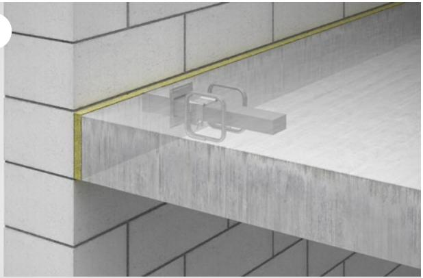
Zweites Bauteil betonieren.
