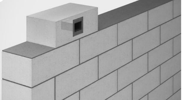
Mauerwerksstein mit eingegossener Hülse verlegen.
