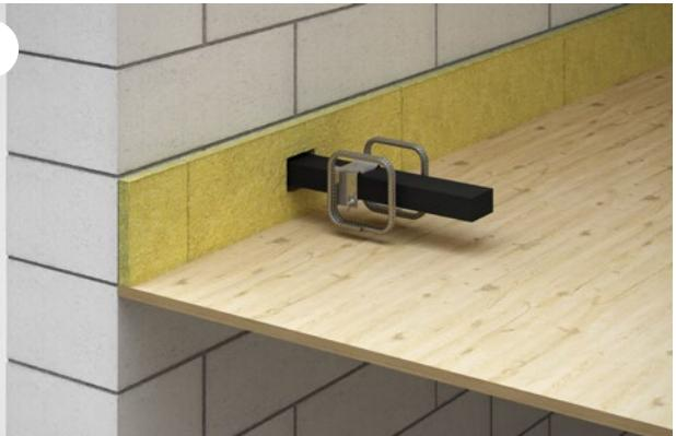
Dorn entsprechend der geplanten Fugenöffnung positionieren.
