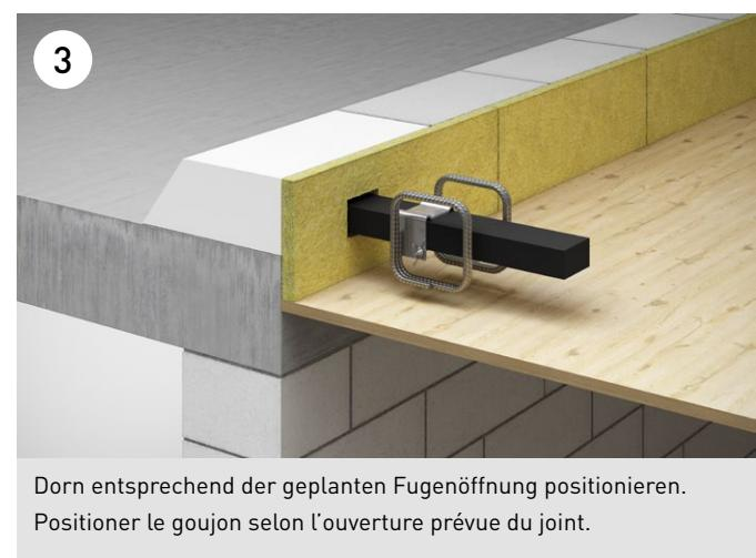
Dorn entsprechend der geplanten Fugenöffnung positionieren.
