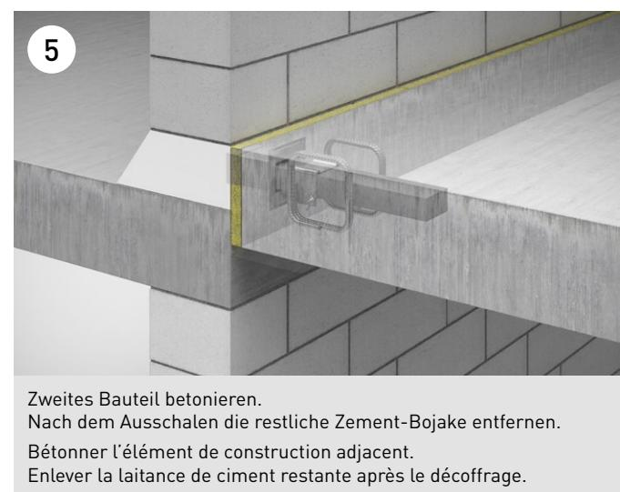
Zweites Bauteil betonieren.
