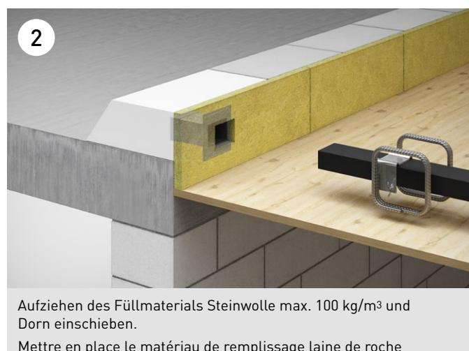
Aufziehen des Füllmaterials Steinwolle max. 100 kg/m<sup>3</sup> und Dorn einschieben.
