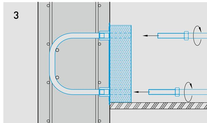
Die Deckenschalung ist erstellt. Das Isolierelement vor dem Schlaufenelement aufstellen. Die Bewehrungsstäbe mit Gewinde ins Schlaufenelement einsetzen und mit einem Schraubenschlüssel fest anziehen.
