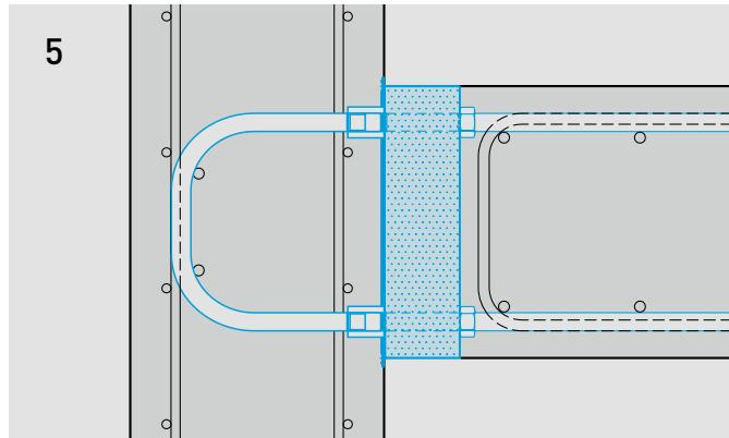
Die Schalung ist entfernt und die Decke kraftschlüssig befestigt.
