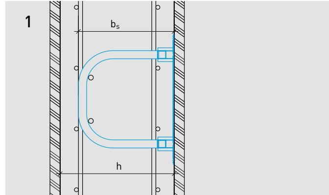
Das Schlaufenelement des ARBO -500 G auf der Wandschalung befestigen. Elementabstand gemäss Ausführungsplan. Die Bewehrung komplettieren und die Wand zuschalen.
