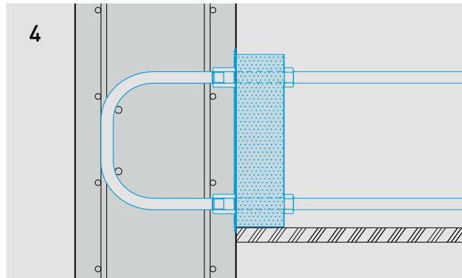
Der ARBO-500 G ist somit komplettiert. Bewehrung verlegen, dann betonieren.
