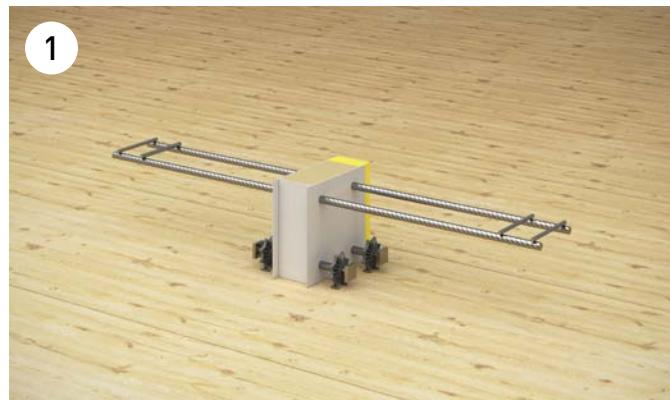
Das ARBO-400E Eckelement weist bei der Zugbewehrung eine Betonüberdeckung von 40 mm auf. Damit ist eine rechtwinklig direkt anschliessende Anordnung zum ARBO-400 Element ohne Konflikte bei den Bewehrungslagen möglich.
