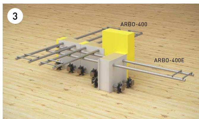
Die genaue Position der einzelnen ARBO Elemente ergibt sich aus der statischen Berechnung (Abstand a). Die Ecke wird durch eine bauseitig angebrachte Isolationseinlage ergänzt.
