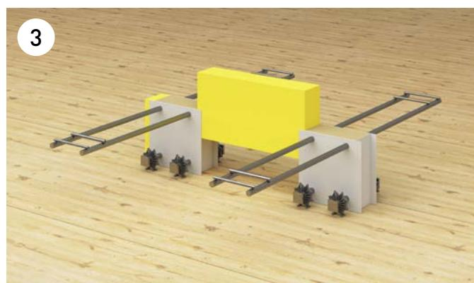
Par la mise en place au chantier d'un panneau de matière isolante, un autre élément ARBO est posé à la distance  $a$  définie par le calcul statique.
