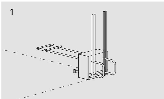
Das ARBO-500 W-E Eckelement mit Aufhängebewehrung weist bei der Zugbewehrung eine Betonüberdeckung von 50 mm sowie eine verkürzte Druckbewehrung auf. Damit ist eine rechtwinklig direkt anschliessende Anordnung zum ARBO-500 W Element ohne Konflikte bei den Bewehrungslagen möglich.
