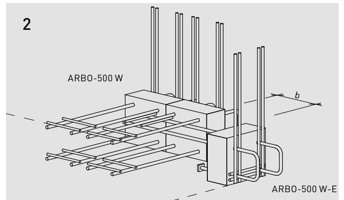
Elementabstand gemäss Ausführungsplan. Das ARBO-500 W-E Element wird auf die Schalung gestellt und seitlich eingeschoben.
