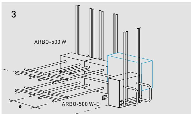
Zwischenstück fugenlos zwischen die ARBO Elemente einfügen. Dämmmaterial gemäss Brandschutzanforderungen wählen.
