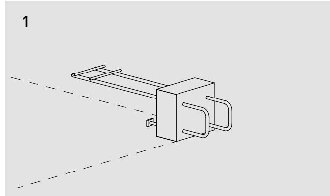
Das ARBO-500 E Eckelement weist bei der Zugbewehrung eine Betonüberdeckung von 50 mm sowie eine verkürzte Druckbewehrung auf. Damit ist eine rechtwinklig direkt anschliessende Anordnung zum ARBO-500 Element ohne Konflikte bei den Bewehrungslagen möglich.
