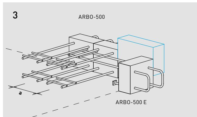
Zwischenstück fugenlos zwischen die ARBO Elemente einfügen.
