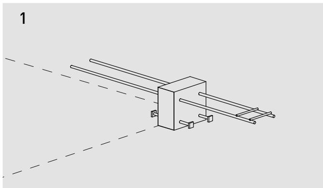
Das ARBO-400 E-D Eckelement in Kombination mit DURA Korb weist bei der Zugbewehrung eine Betonüberdeckung von 50 mm auf. Damit ist eine rechtwinklig direkt anschliessende Anordnung zum ARBO-400 Element im Bereich eines DURA Korbes ohne Konflikte bei den Bewehrungslagen möglich.
