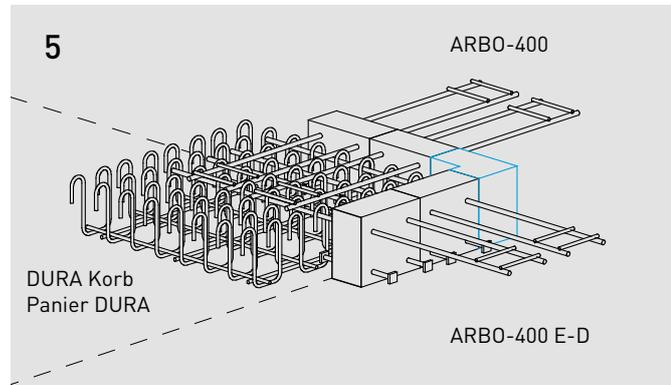
Zwischenstück fugenlos zwischen die ARBO Elemente einfügen.
