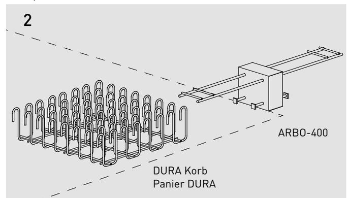
Die 1. Bewehrungslage, der DURA Korb und die 2. Bewehrungslage inkl. Randbügel sind verlegt. Das ARBO Element wird über den DURA Korb auf die Schalung gestellt.
