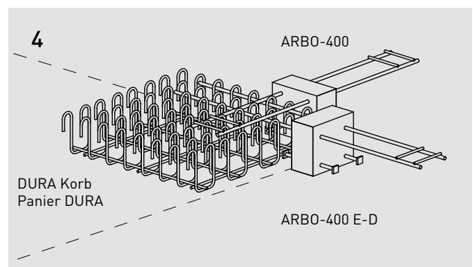
Das ARBO-400 E-D Element wird seitlich in den DURA Korb eingeschoben.
