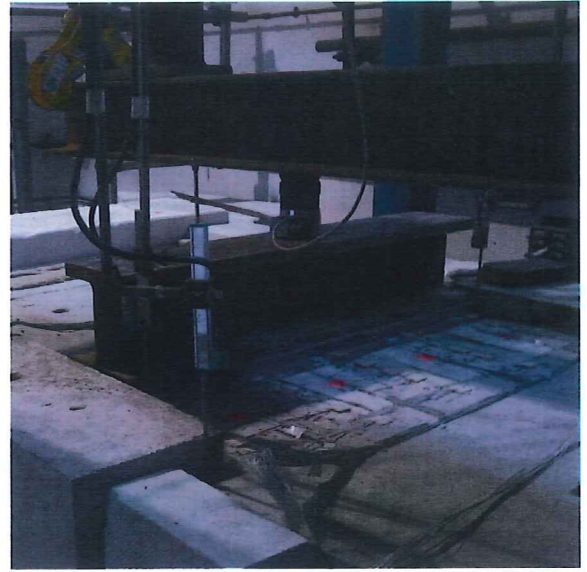
Figure 4 Détail Zone d'introduction de la charge avec capteur de force et calotte pour compenser les inclinaisons non voulues
