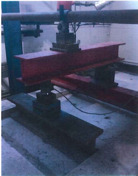
Figure 3 Dispositif expérimental avec dérivation de la charge dans les échantillons d'essai
