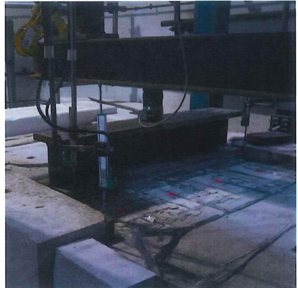
Bild 4 Detail Lasteinleitungsbereich mit Kraftmessdose und Kalotte zum Ausgleich ungewollter Schiefstellungen
