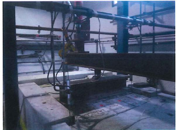
Bild 6 Anordnung der Oberflächenmessstellen
