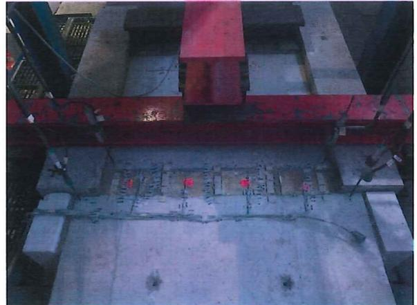
Bild 6 Anordnung der Oberflächenmessstellen
