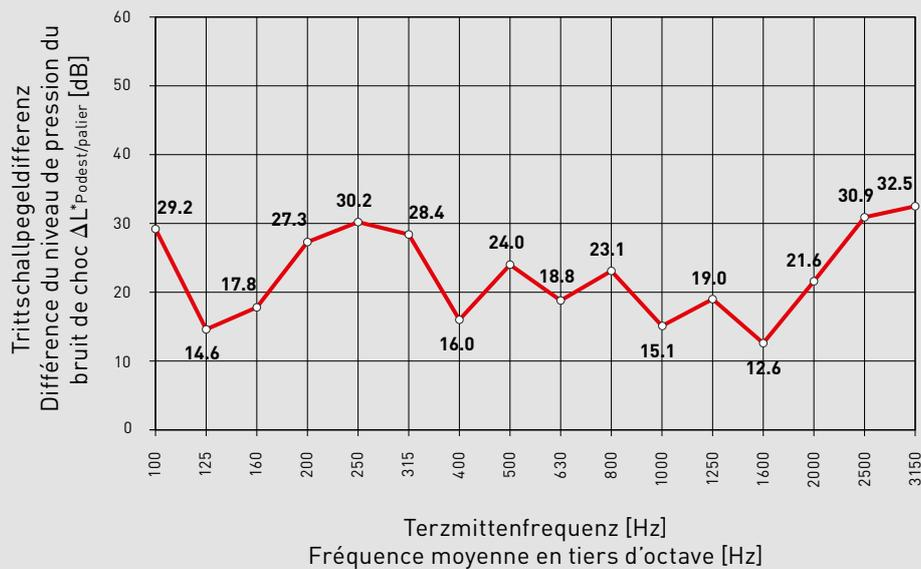
Bild 8: Ergebnisse der Messungen am Fraunhofer-Institut IBP; Podest-Trittschallpegeldifferenz eines CRET Silent-993 Querkraftelements bei maximaler Last. Weitere spektrale Werte zur Podest-Trittschallpegeldifferenz und Podest-Trittschallminderung sind im Messbericht abgebildet.
