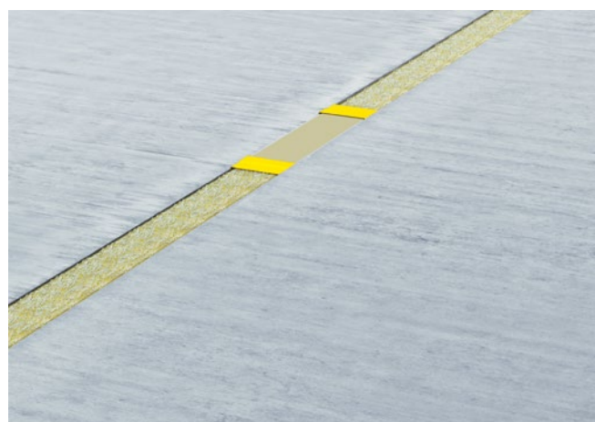
4. Bétonner la deuxième plaque.
