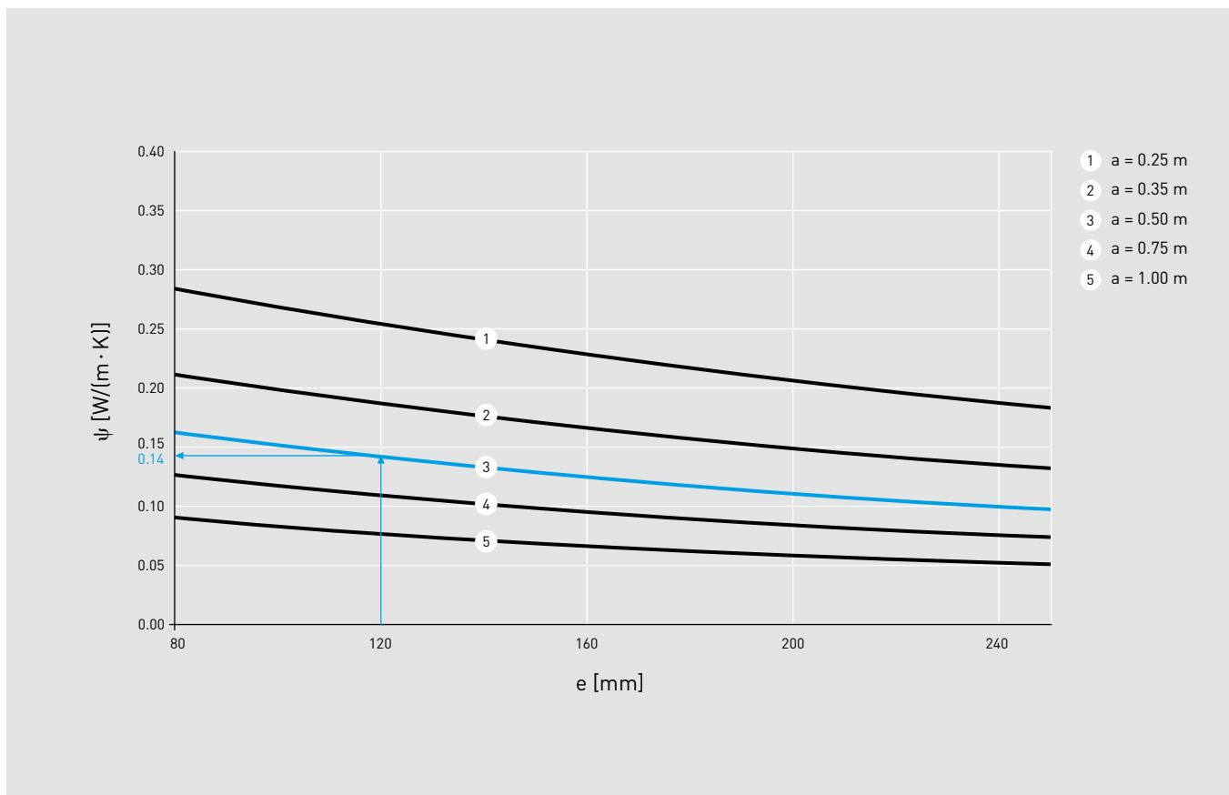
Das Diagramm zeigt den längenbezogenen Wärmedurchgangskoeffizienten  $\psi$  in Abhängigkeit der Dämmstärke  $e$  und des Elementabstandes  $a$ . Details zur Modellierung befinden sich in der ARBO Einführungsdokumentation.
