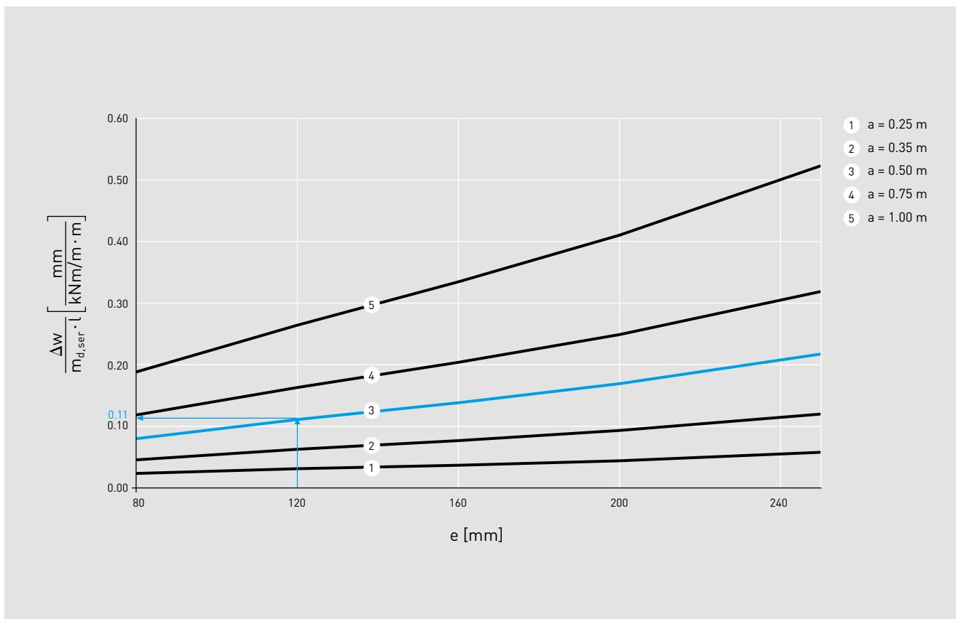
Das Diagramm zeigt die ungefähre Zusatzverformung infolge der reduzierten Biegesteifigkeit der ARBO Elemente im Dämmbereich bei Kragplattenanschlüssen. Dieser Wert ist zur Verformung der Stahlbetonplatte zu addieren:
