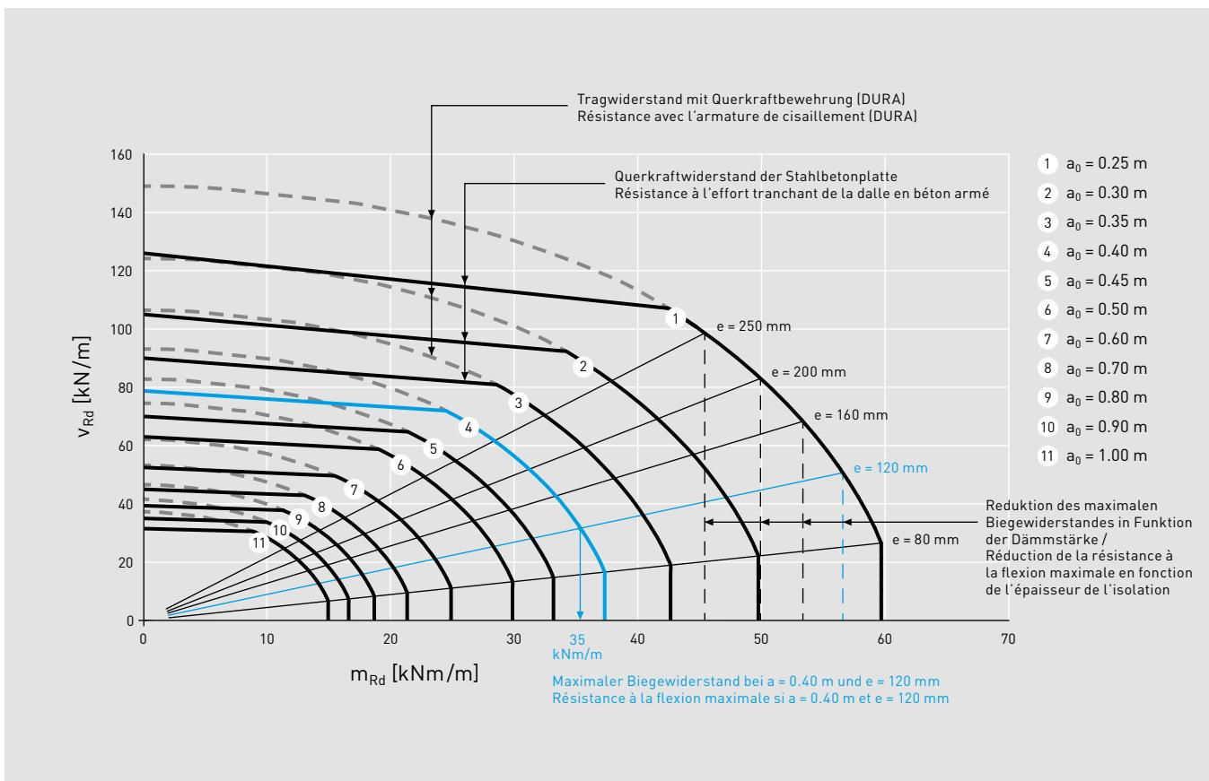
Das Interaktionsdiagramm zeigt den Querkraftwiderstand und Biegewiderstand an. Der Tragsicherheitsnachweis ist erfüllt, wenn der Punkt  $(m_d, v_d)$  innerhalb der Interaktionskurve mit dem entsprechenden Elementabstand liegt. Dabei gilt es folgende Hinweise zu beachten:
