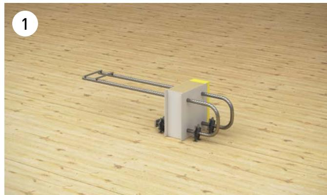
Das ARBO-500E Eckelement weist bei der Zugbewehrung eine Betonüberdeckung von 40 mm sowie eine verkürzte Druckbewehrung auf. Damit ist eine rechtwinklig direkt anschliessende Anordnung zum ARBO-500 Element ohne Konflikte bei den Bewehrungslagen möglich.
