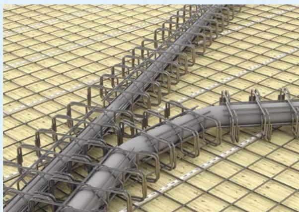
**Variante** avec plusieurs conduites. Avec des conduites courbes, couper la DURA® Box sur un côté ou sur les deux.
