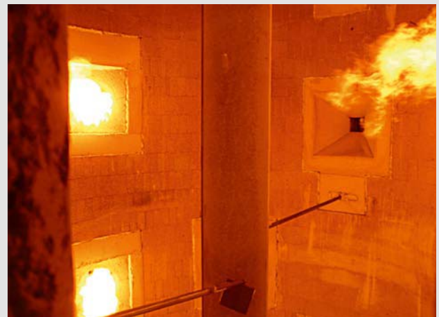
Figure 6: Essai de résistance au feu en charge dans la Bundesanstalt für Materialforschung und -prüfung (BAM), Berlin, mai 2013. Vue du four d'essai pendant le chauffage (photo: Aschwanden SA)
