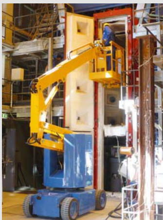
Figure 5: Opérations dans le four d'essai ouvert pour colonnes dans la Bundesanstalt für Materialforschung und -prüfung (BAM), Berlin (photo: Aschwanden SA)
