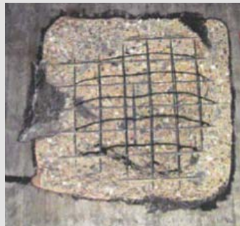
Figure 3: Béton C25/30, teneur en ciment 325 kg/m 3 , proportion eau-ciment 0.42, teneur en air occlus 1.5%, teneur en fibres en PP 1.0 kg/m 3 [15]
