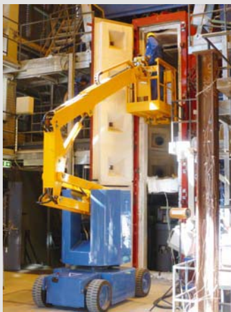
Bild 5: Arbeiten am offenen Stützenbrandofen an der Bundesanstalt für Materialforschung und -prüfung (BAM), Berlin (Foto: Aschwanden AG)
