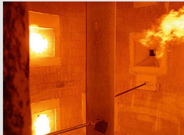
Bild 6: Brandversuch unter Last an der Bundesanstalt für Materialforschung und -prüfung (BAM), Berlin, Mai 2013. Blick in den Brandofen während der Befuerung (Foto: Aschwanden AG)
